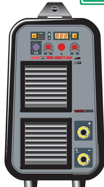
Il generatore trifase **SOUND MMA 3536/T Cell** (art. 335) permette la saldatura professionale di elettrodi rivestiti, tramite le funzioni di Hot Start ed Arc Force che garantiscono un controllo sofisticato della condizione di corto circuito, e, quindi, del trasferimento della goccia, che è il parametro che più influenza la qualità della saldatura.
