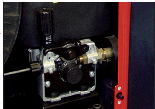
Foto del vano bobina con trainafilo a 2 rulli
