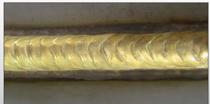
BRASATURA CON FILO CuAl 8 BRAZING WITH CuAl 8 WIRE
